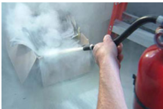
S. Quét vòi phun hay ống xịt từ bên này sang bên kia cho đến khi đám cháy được dập tắt
